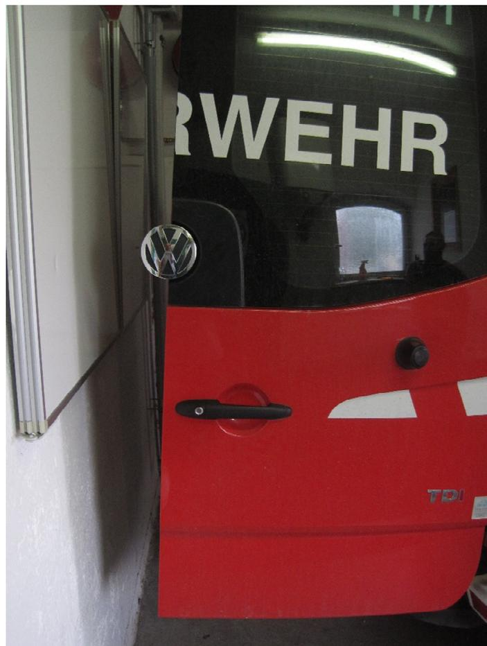
Der Abstand zwischen dem Mehrzweckfahrzeug MZF und der Hallenwand ist nicht ausreichend. Bei geöffneten Türen eines Fahrzeuges müssen mind. 50
