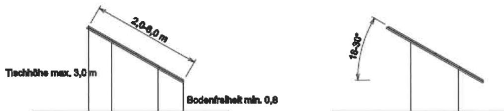
Abb. 5: N-S Schnitt Modultische
